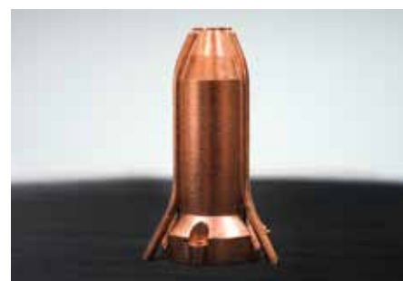
Selbst konstruiert: Toolcraft hat diese LMD-Düse additiv gefertigt.
