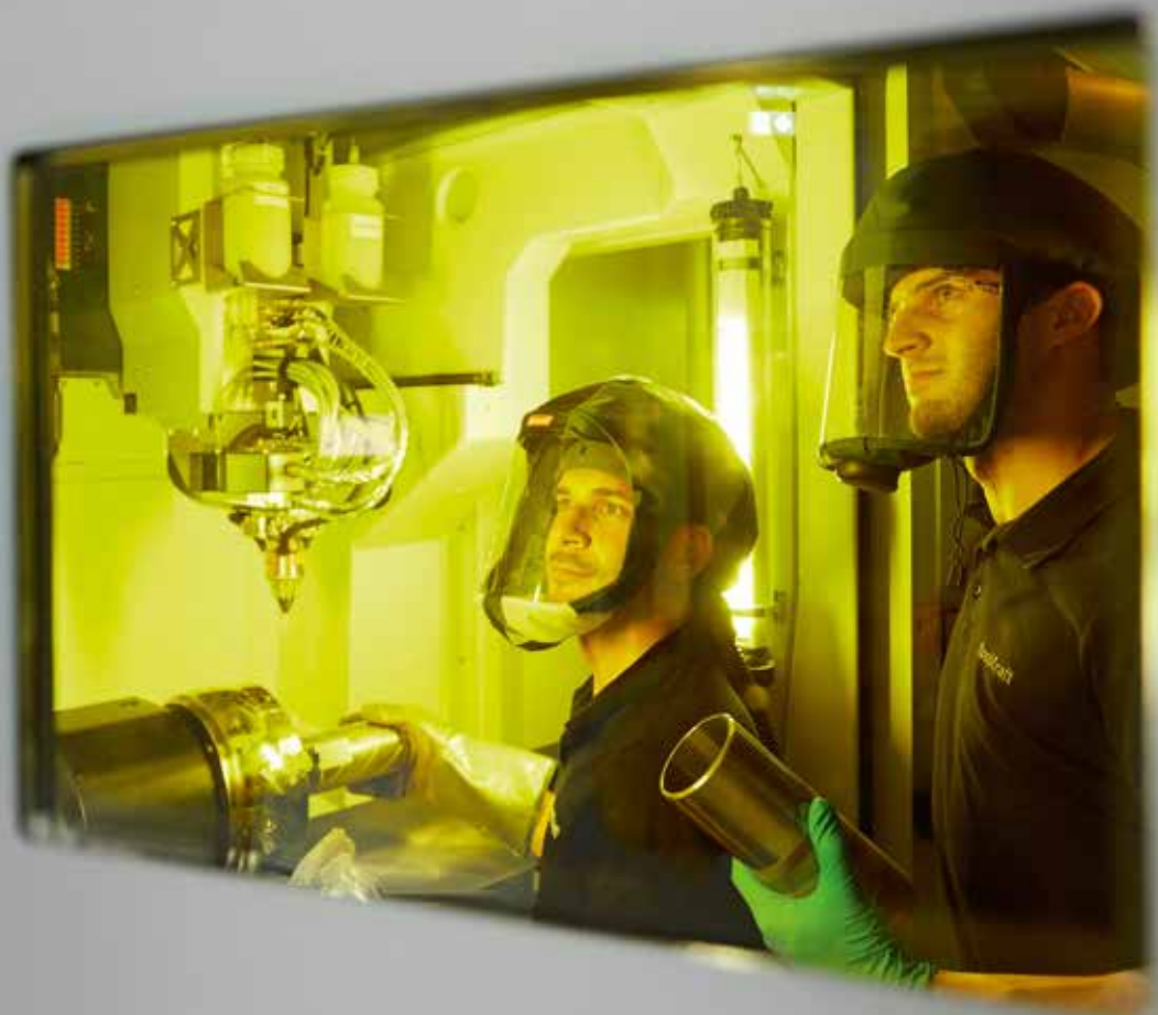
Zwei Mitarbeiter richten die LMD-Anlage ein.
