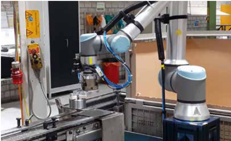
Die intelligente Robotersteuerung übernimmt bei der ZF Group das teilsortierte Picken von zufällig angeordneten, reflektierenden Ringen für die Zahnradproduktion.
