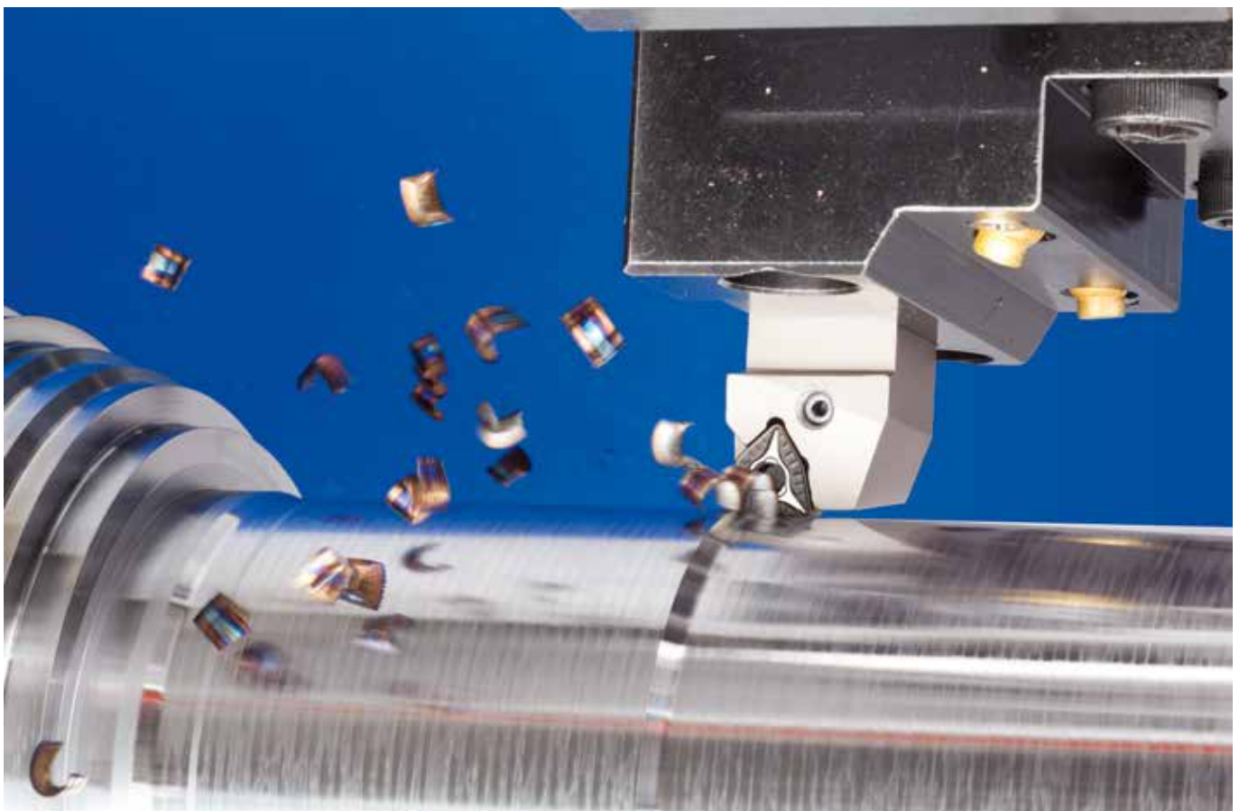
Die Einstellwinkel bei dieser Hochvorschub-Variante erreichen eine geringere Spandicke bei vergleichbar hohen Vorschüben. Dies sorgt für eine reibungslose Spanabfuhr und hohe Prozesssicherheit.
