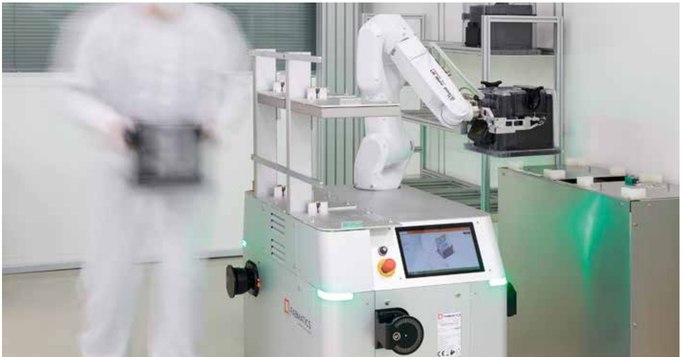
Leichtbauroboter sparen Energie, arbeiten genau und ersetzen in vielen Anwendungen klassische Industrieroboter.
