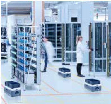
Magnetisch-optische Spurführungen sind einfach aufzubringen, aber nicht dynamisch anpassbar.
