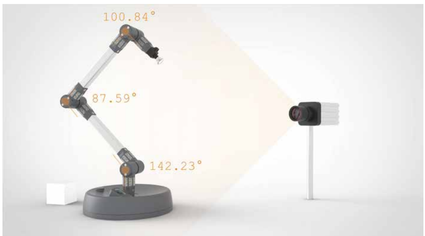
Kamerabasierte Sensorik für Gelenkwinkel: Die Kamera beobachtet den Arm, eine Software errechnet die Gelenkwinkel in Realzeit aus dem Bild. Enkoder im Arm sind zur Steuerung nicht nötig.
