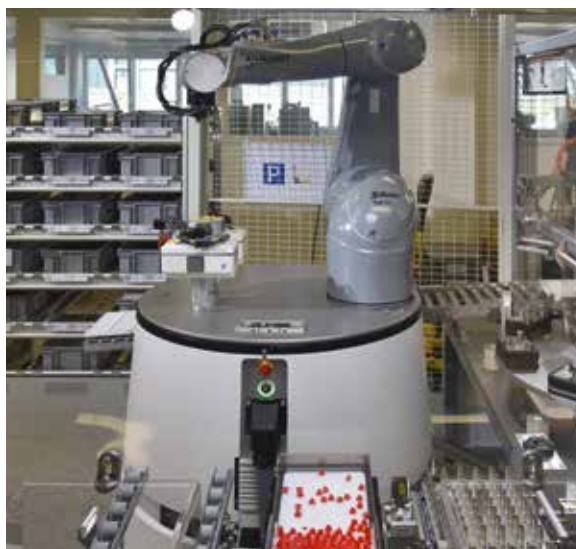
Der mobile Roboter positioniert sich selbst an seinem Arbeitsplatz und beginnt mit dem Bestücken des Rundtaktisches.
