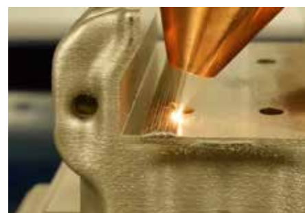
Mittels LMD-Verfahren fügt die Pulverdüse Komponenten zu Baugruppen zusammen.
