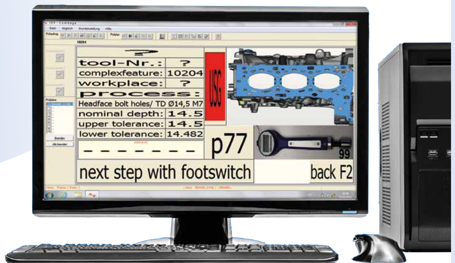
4 PC mit DIA-Gauge Software; Laptop mit Software zur Prozessüberwachung PC with DIA-Gauge software; Laptop with Software for process control
