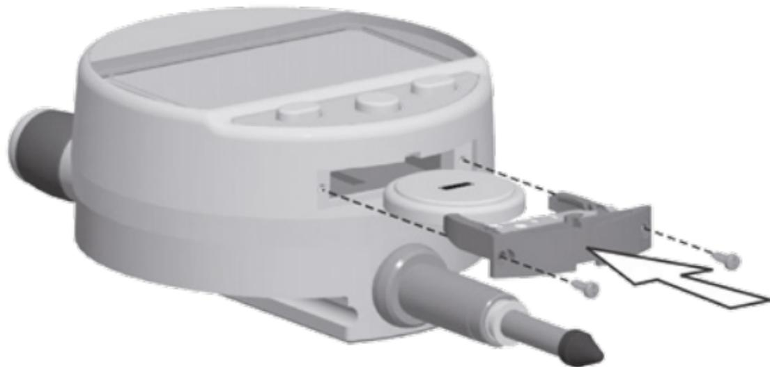
**Battery** / batterie / **Batterie** / batteria / **bateria** : lithium 3V, type CR2032
